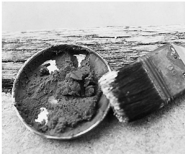
Fig. 3 On prépare une pâte composée de trichloréthane et de bentonite.
