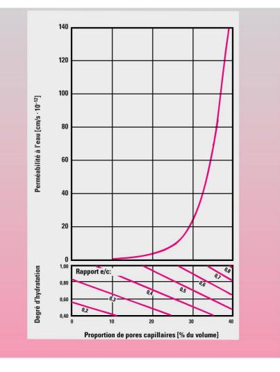
Fig. 3 Relation entre porosité capillaire et perméabilité à l'eau de la pâte de ciment durcie en fonction du rapport e/c et du degré d'hydratation (selon *Powers*) [4].
