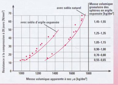
Abb. 1 Masses volumiques apparentes et résistances à la compression à 28 jours de bétons légers avec granulats en argile expansée de différentes masses volumiques granulaires (d'après [3, 5], modifié).
