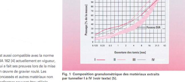
est aussi compatible avec la norme SIA 162 [4] actuellement en vigueur, qui a fait ses preuves lors de la mise en œuvre de gravier roulé. Les concassés et autres matériaux non conformes peuvent être utilisés comme granulats, à condition que leur convenance soit contrôlée au moyen d'essais préliminaires. Il est fait largement usage de cette possibilité lors de l'utilisation de matériaux extraits par tunnelier.
