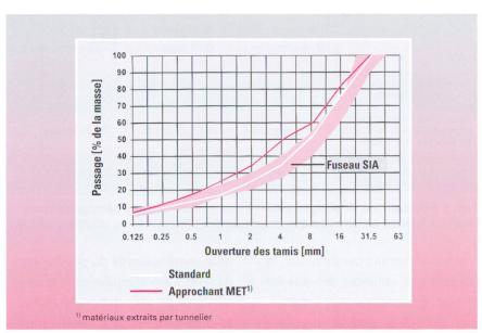
Fig. 2 Courbes granulométriques des granulats pour essais de bétonnage avec des matériaux extraits par tunnelier «améliorés» (modifié, selon [1]).
