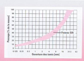
Fig. 2 Si la courbe granulométrique des granulats naturels roulés n'est pas fixée par des essais préliminaires, elle doit, selon la norme SIA 162 [2], se situer à l'intérieur de la zone hachurée («fuseau SIA»).
