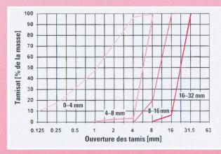
Fig. 6 Courbes granulométriques des différents composants.
