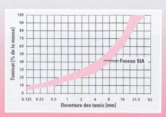
Fig. 5 Selon la norme SIA 162, la composition granulométrique des granulats naturels roulés dont la courbe granulométrique n'a pas été fixée par des essais préliminaires, doit se situer à l'intérieur du fuseau hachuré («fuseau SIA»).
