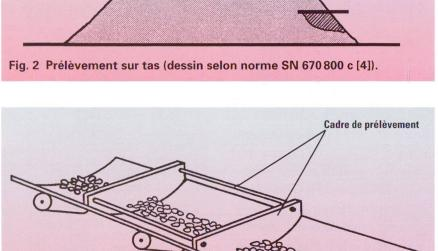
Fig. 3 Prélèvement d'échantillons au moyen du cadre de prélèvement avec bande transporteuse à l'arrêt (dessin: norme SN 670 800 c [4]).
