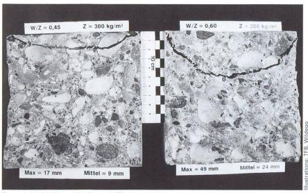
Etanchéité à l'eau de deux différents bétons.
