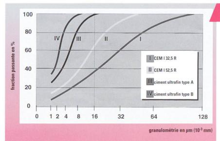
Fig. 1 Comparaison de la répartition granulométrique des ciments ordinaires et des ciments ultrafins (selon [4]).
