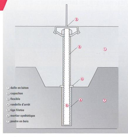
Schéma 4 Structure d'une cheville d'injection montée (selon [16, 17]). Dessin: TFB / S. Einfalt ZSD
