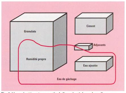
Fig. 1 L'eau ajoutée est une partie de l'eau de gâchage, laquelle se compose également de l'humidité propre des granulats et de l'eau contenue dans les adjuvants et ajouts.
