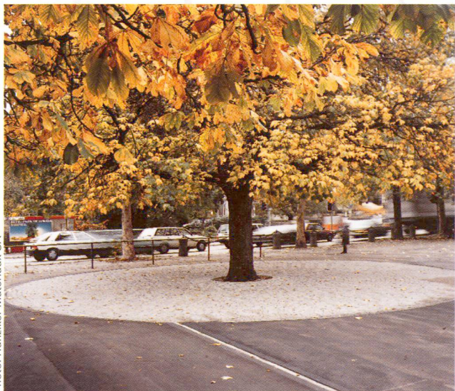
Les pavés-drains en béton assurent l'arrivée d'eau et d'air dans la zone des racines d'arbres.
