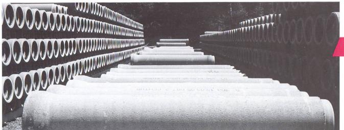
Tuyaux en béton contenant des cendres volantes.
