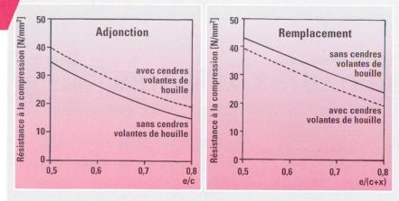
Figure 1 Résistance à la compression en fonction du genre de cendres volantes ajoutées (x = cendres volantes de houille) [9]. Graphique: TFB/ZSD, S. Einfalt
