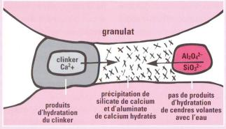
Figure 3b Représentation schématique de la réaction de cendres volantes en présence de clinker de ciment Portland hydraté (selon [9]). Graphique: TFB/ZSD, S. Einfalt
