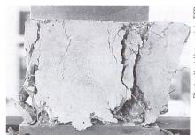
Le béton contenant des fibres d'acier témoigne d'une résistance à la traction de flexion plus élevée avant la rupture définitive; en cas de contrainte de compression, il ne rompt pas sitôt après l'apparition de fissures.
