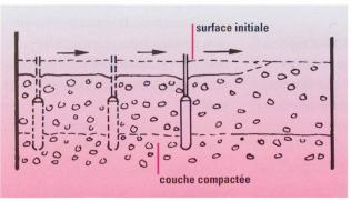
Fig. 2 Utilisation correcte du vibrateur interne. L'aiguille immergée verticalement à distances régulières arrive jusque dans la couche inférieure compactée (selon [10]).
