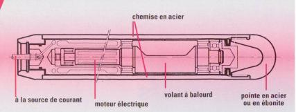
Fig. 1 Représentation schématique d'un pervibrateur avec moteur triphasé incorporé.
