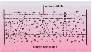
Fig. 3 Mauvaise utilisation du vibrateur interne: espacement irrégulier des points d'entrée dû à une introduction avec inclinaison d'angle inégale, ainsi qu'à une vibration insuffisante de la couche déjà compactée (mod. selon [10]).
