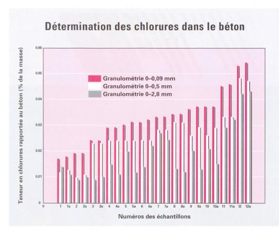
Influence de la granulométrie sur la détermination de la teneur en chlorures dans le béton.
