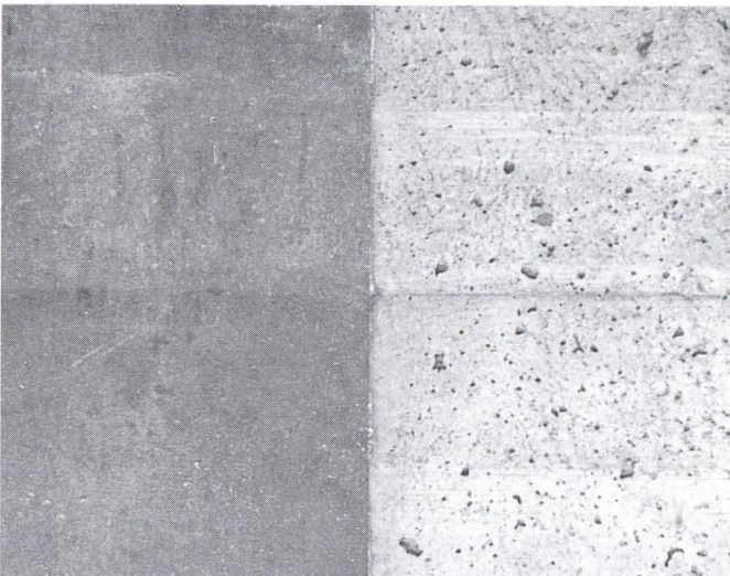
Influence exercée sur la surface du béton par les lés de coffrage dissipant l'eau: à droite, coffrage non absorbant, à gauche, coffrage non absorbant recouvert de Zemdrain.
