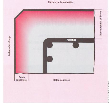
Schéma 1. Béton superficiel et béton de masse dans un élément de construction armé (selon [1]).
