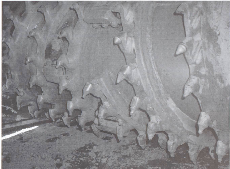
Scarificateur du Coldmixer Spécial (en haut) et rotor de la Ra-Co 250 (en bas).
