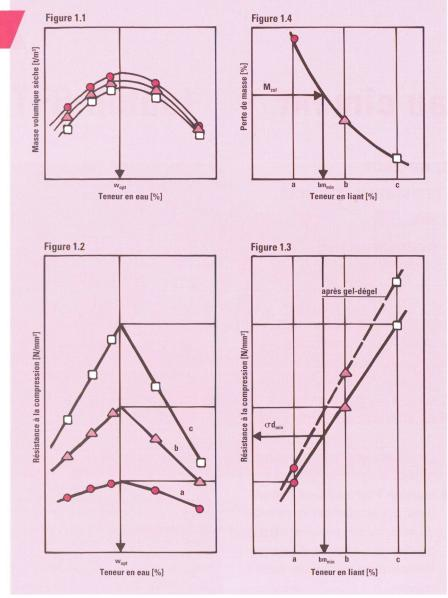
Relations entre la masse volumique sèche et la teneur en eau (figure 1.1), la résistance à la compression simple et la teneur en eau (figure 1.2), la résistance à la compression simple et la teneur en ciment (figure 1.3), ainsi qu'entre la perte de masse après douze cycles de gel-dégel et la teneur en liant (figure 1.4), selon [1].
