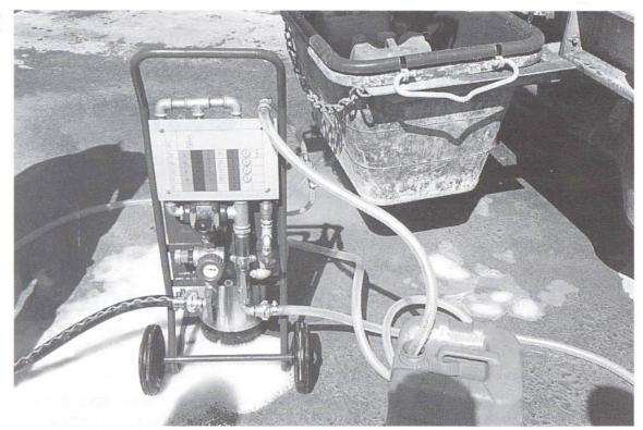
Appareil simple pour la production de mousse.
