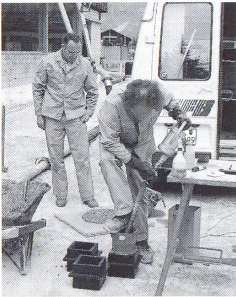
Compactage du béton au moyen d'un vibreur.
