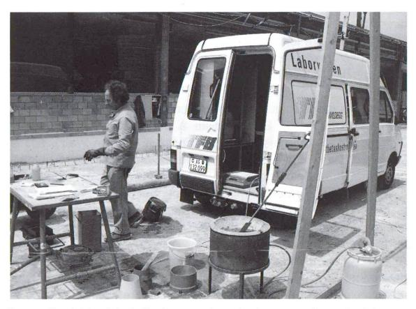
Des contrôles du béton frais significatifs peuvent être exécutés au moyen d'appareils relativement simples. (Photos: Kurt Haberstich, TFB)
