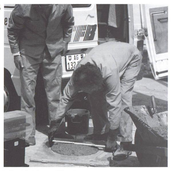
La détermination de la mesure d'étalement.
