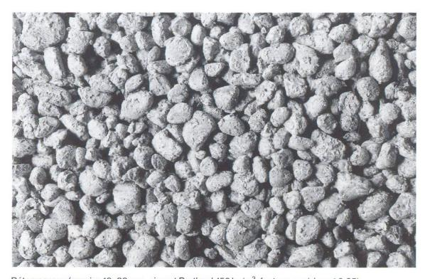
Béton poreux (gravier 16–32 mm, ciment Portland 150 kg/m³, facteur eau/ciment 0,35).
