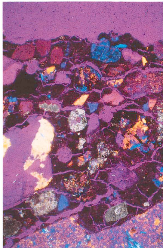
Examens microscopiques en coupes minces d'un échantillon de béton incendié: les températures élevées ont provoqué des fissures dans la pâte de ciment durcie, dans la zone de liaison granulats/pâte de ciment durcie et dans les granulats. (Coupe: 2,7×1,8 cm; à gauche, lumière fluorescente; à droite, lumière polarisée et lame \lambda .) (Photo: TFB)
