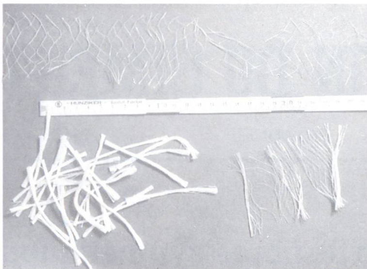
Fibres de polypropylène fibrillées telles qu'elles sont livrées (en bas à gauche), ainsi qu'à deux stades de la dispersion. (photos: T. Steiner)
