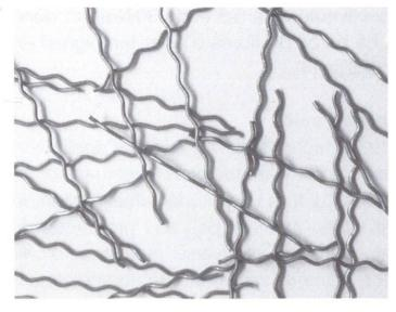
Fig. 6. Fibres rondes, ondulées (60×1 mm).
