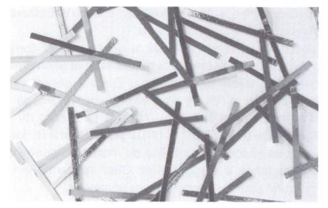
Fig. 3. Fibres lisses (longueur: 20 mm, largeur: 1,0 mm).
