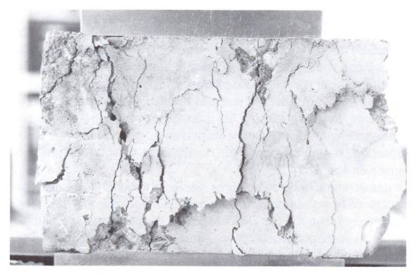
Fig. 2. Le béton de fibres d'acier sollicité en compression ne se désagrège pas sitôt après la fissuration. (photos: TFB)
