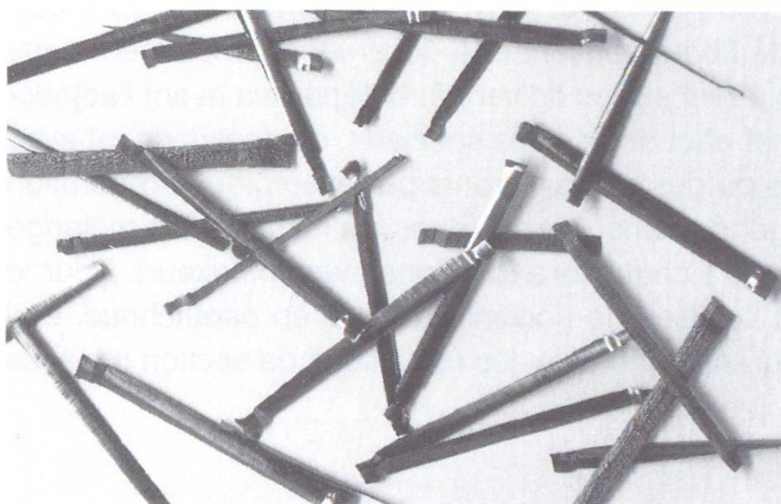
Fig. 4. Fibres fraisées avec ancrages aux extrémités (longueur: 32 mm).
