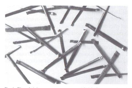
Fig. 4. Fibres fraisées avec ancrages aux extrémités (longueur: 32 mm).
