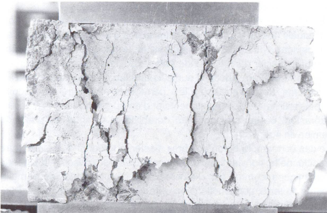
Fig. 2. Le béton de fibres d'acier sollicité en compression ne se désagrège pas sitôt après la fissuration. (photos: TFB)
