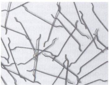
Fig. 7. Fibres plates avec extrémités recourbées (30×0,5 mm).
