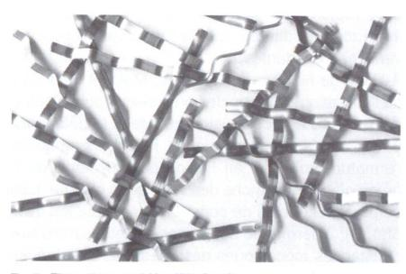
Fig. 5. Fibres plates, ondulées (50×2 mm).
