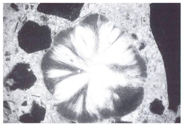
Pores remplis d'ettringite dans de la pâte de ciment durcie carbonatée (prise de vue sous lumière fluorescente, coupe 0,72 × 1,08 mm). (photo: TFB, Vernier)
