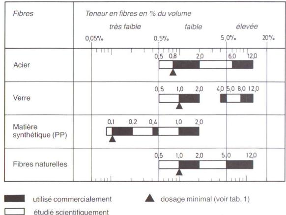
Fig. 2 Zones de travail techniques avec différentes fibres, mesurées d'après la teneur dans le produit fini (en % du volume). Représentation à l'échelle logarithmique, selon [2].
