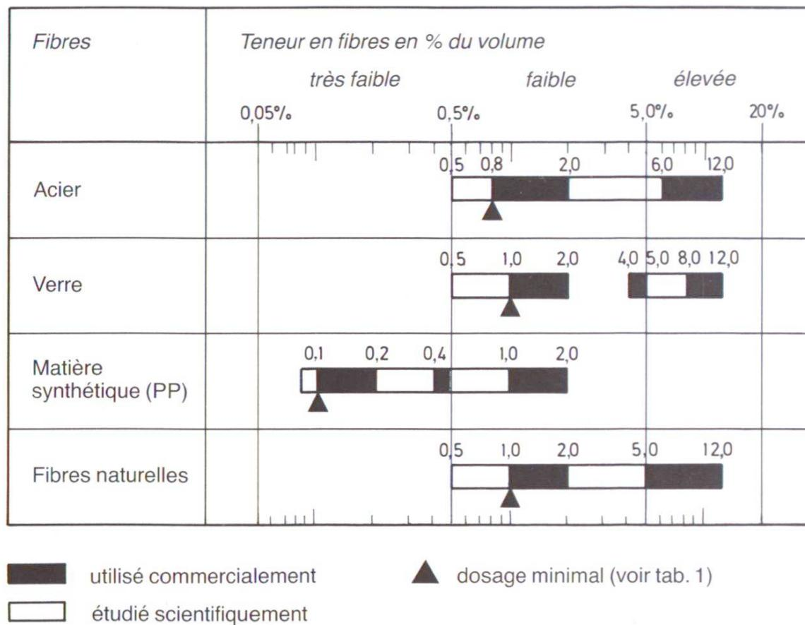
Fig. 2 Zones de travail techniques avec différentes fibres, mesurées d'après la teneur dans le produit fini (en % du volume). Représentation à l'échelle logarithmique, selon [2].
