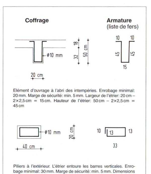
Fig. 1 Exemples pour armature dans la liste de fers sur la base du plan de coffrage.
