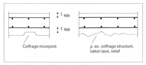
Fig. 3 Observer les valeurs minimales même avec des changements de sections.
