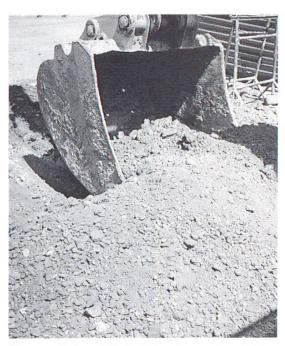
Fig. 3 Sol stabilisé à la chaux (maniable, grumeleux)
