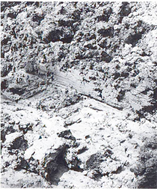
Fig. 2 Sol en place (collant, gorgé d'eau)
