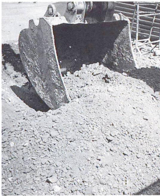
Fig. 3 Sol stabilisé à la chaux (maniable, grumeleux)
