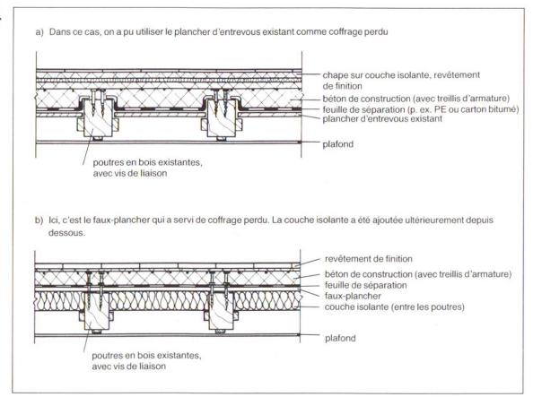
Fig. 2 Structure d'un plancher à solives en bois renforcé
