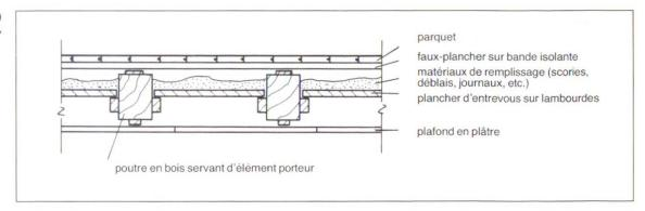
Fig. 1 Structure d'un plancher à solives en bois traditionnel. Pour les rénovations, l'état de choses doit être relevé in situ (hauteur et espacement des poutres, état du bois et des appuis)
