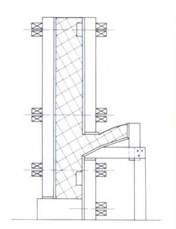
Phase 2. Journée de bétonnage: mettre le béton en place et le vibrer. Malgré les formes libres, le coffrage doit être jointif et stable.
