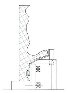
Phase 3. Contrôler la dureté et décoffrer la face avant. Etayer les parties en saillie. Tailler grossièrement les surfaces apparentes au pic (stries, creux, etc.). Relief en grande partie déjà réalisé.
