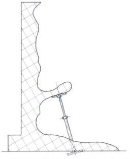
Phase 4. Retouches à la boucharde ou au marteau de géologue jusqu'à ce que l'on ait obtenu la forme voulue. Brosser avec un balai de bouleau et nettoyer au jet à haute pression. Finition du sol, éventuellement avec des évidements. Enlever le reste du coffrage. Appliquer l'enduit de couleur.
