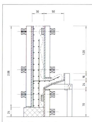
Phase 1. Coffrage deux faces, posé sur socle en béton. Mise en place de l'armature. (Le volume de ce qu'il est prévu d'enlever peut être réservé au moyen de pièces de bois ou de styropor irrégulièrement insérées.)
