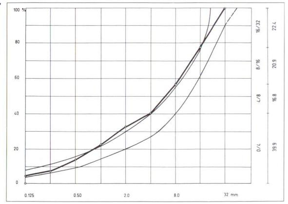
Fig. 6a Mélange d'essai B. Courbe granulométrique constante avec plus grande fraction de sable
