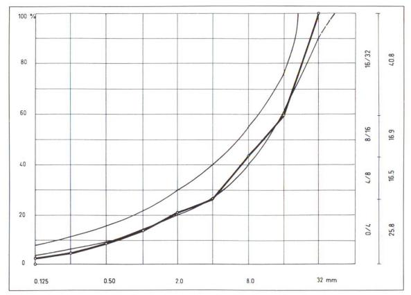
Fig. 5a Mélange d'essai A. Courbe granulométrique constante avec faible fraction de sable. Abscisses: ouverture des tamis. Ordonnées: tamisat en % de la masse. Le fuseau granulométrique selon la norme SIA 162 (1989) est également dessiné
