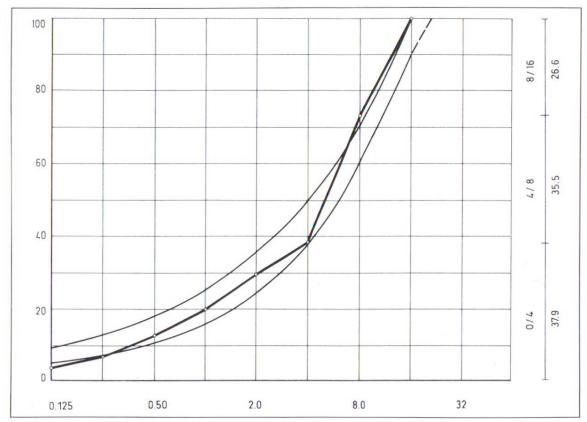
Fig. 9a Mélange d'essai E. Courbe granulométrique constante pour un granulat de diamètre maximum de 16 mm. Le fuseau granulométrique n'est plus normé pour ce diamètre maximum de granulat. Pour la comparaison, on a dessiné le fuseau granulométrique au moyen des formules selon la norme SIA 162 (1968)
