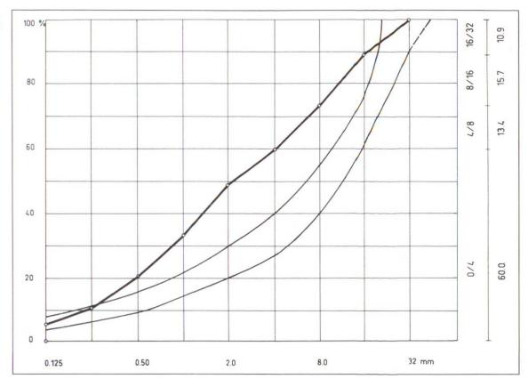
Fig. 7a Mélange d'essai C. Mélange riche en sable, situé en dehors du fuseau granulométrique recommandé
