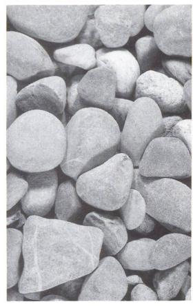
3 La forme des grains influence la maniabilité ou la masse volumique apparente du béton. Les grains ronds et arrondis permettent un bon compactage. Les plats et les colonnaires s'entassent de façon moins compacte, et exigent donc une plus grande proportion de fines pour un compactage parfait. En dehors de ces granulats naturels, on utilise également des granulats concassés, ce qui influence la maniabilité et la résistance mécanique.
