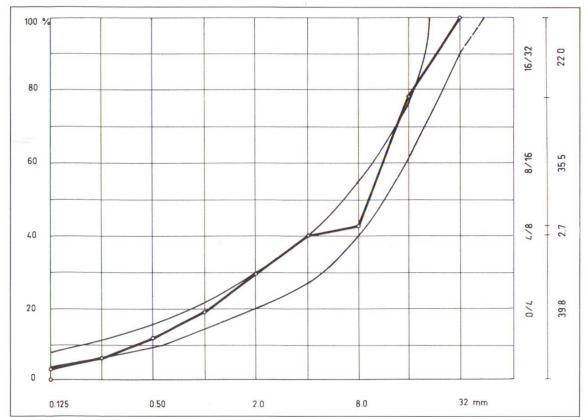
Fig. 8a Mélange d'essai D. Courbe avec granulométrie discontinue. La classe granulaire 4/8 n'a pas été intégrée au mélange. Les grains de 4 et 8 mm tout de même présents sont des déclassés inférieurs ou supérieurs des autres classes granulaires
