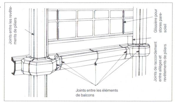
Fig. 4 Eléments de façades avec les détails de joints critiques
