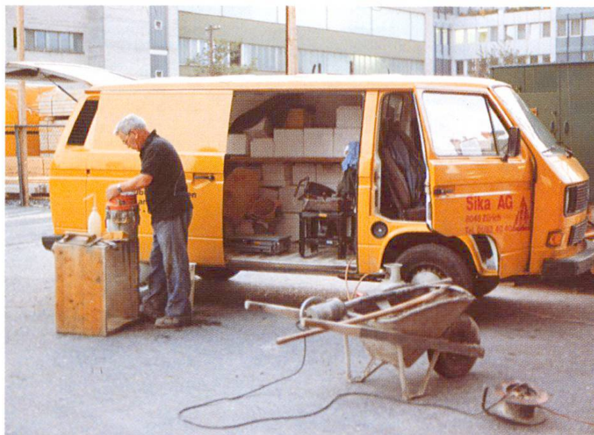
Fig. 2 Contrôles du béton frais. Des prélèvements sont faits pour la densité apparente, la teneur en eau, le pourcentage de pores d'air, le degré de serrage et la température du béton frais. Simultanément: fabrication de cubes d'essai pour la résistance.
