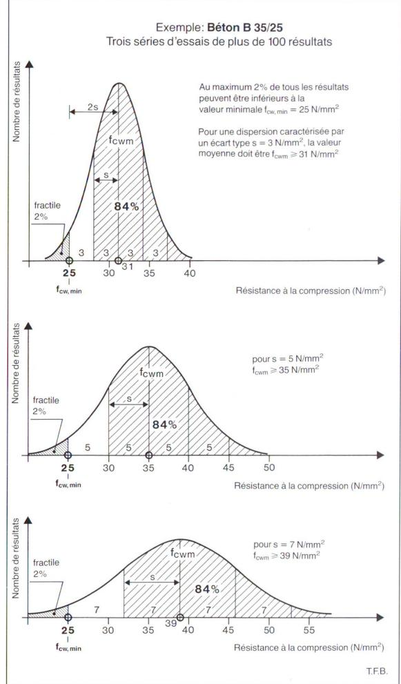
Fig. 3 Contrôles réguliers d'un béton B 35/25: trois séries d'essais avec des dispersions différentes. Ce qui doit être assuré, c'est la valeur minimale. Quand la dispersion est grande, la valeur moyenne à atteindre doit être plus élevée.
