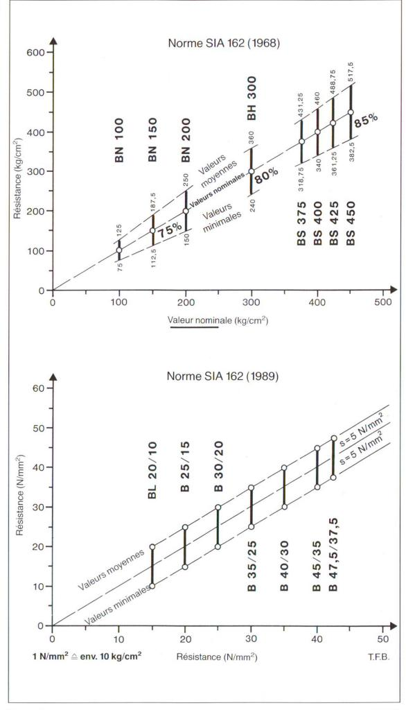
Fig. 5 Comparaison entre les valeurs nominales des résistances du béton, selon norme SIA 162. En haut: édition 1968, en bas: édition 1989.
