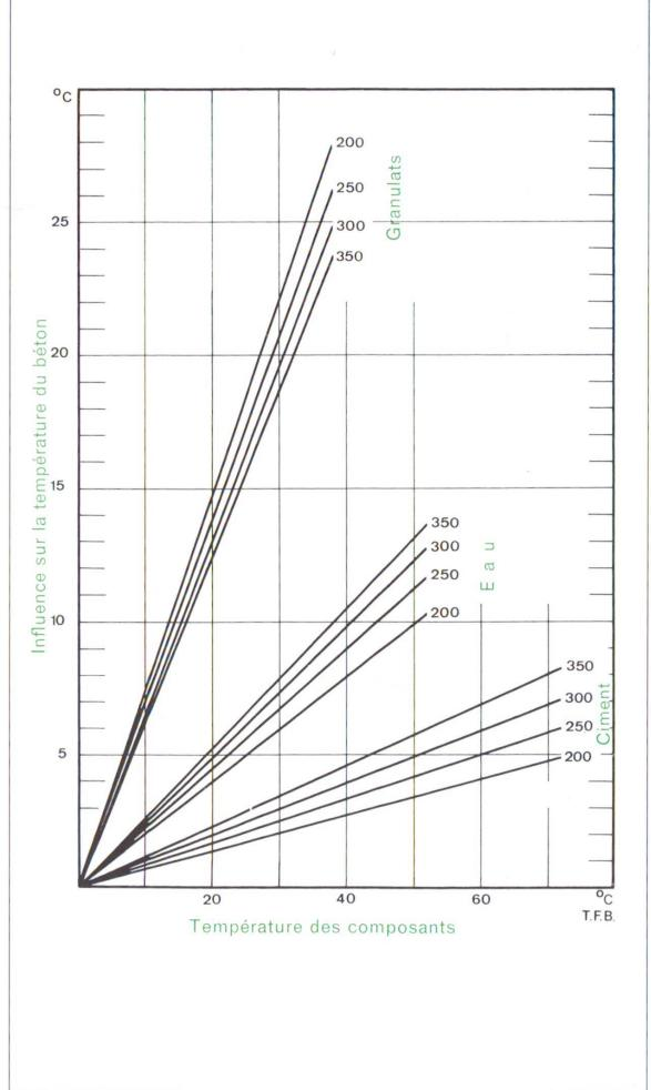
Fig. 1 Diagramme permettant de déterminer la température du béton frais à partir de celles des granulats, du ciment et de l'eau de gâchage, pour des dosages en ciment de 200, 250, 300 et 350 kg/m³. La somme des températures lues en ordonnée donne celle du béton frais.
