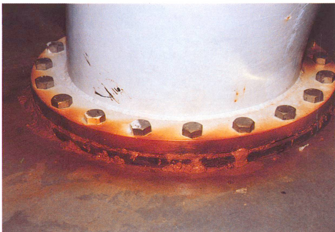
Fig. 4 Dégâts par corrosion dans un réservoir d'eau potable après 5 ans d'exploitation (même exécution que fig. 3).
