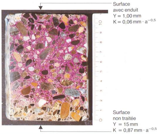
montre un échantillon où la carbonatation est pratiquement stoppée par un enduit de protection. Il est ainsi également possible de comparer entre eux différents systèmes d'assainissement.
