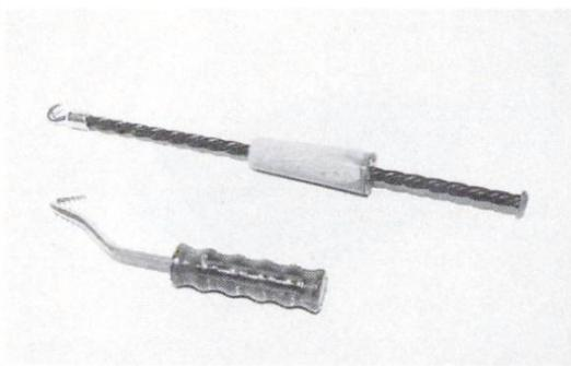
**Outil à ligaturer (tourniquet).** Le ferrailleur l'utilise pour serrer, en torsion, les ligatures et les fils d'attache des cales de distance. Après torsion, ces fils doivent être repliés vers l'intérieur. 19
