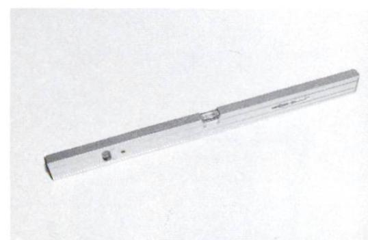
**Niveau à bulle.** C'est la règle du maçon. Il est souvent utilisé avec la latte et permet de contrôler les différentes horizontales et verticales. 4
