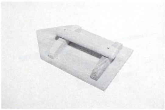
**Frottoir pointu.** Il est utilisé dans les travaux de crépi et d'enduit. On obtient différentes structures superficielles des enduits suivant la nature de la surface du frottoir. 16
