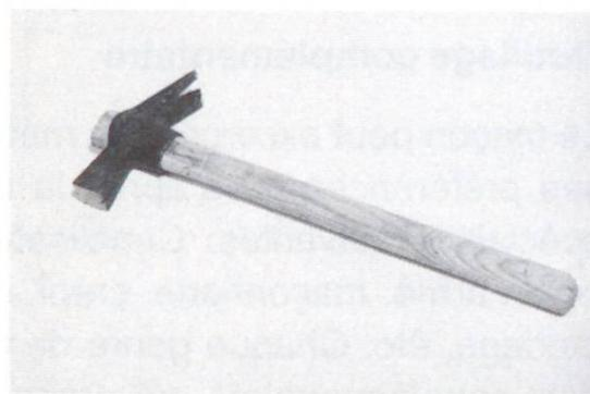
**Marteau de coffreur.** Outil universel pour les travaux de coffrage. Il sert à planter les clous et à chasser ou libérer les coins des tendeurs de tirant. La panne fourchue permet d'arracher les clous. 12
