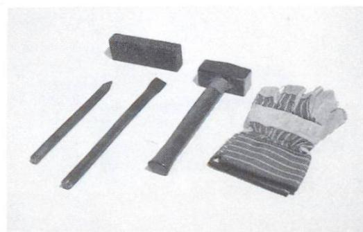
**Gants:** Ils doivent être portés s'il y a risque de blessure. **Massette, ciseau** et **burin** sont utilisés pour entailler la pierre ou le béton. La **pierre de carbure** permet d'éliminer les coulures et de polir les surfaces et les arêtes de béton. 20
