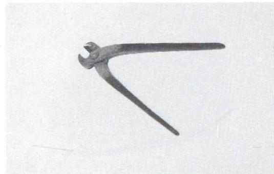
**Tenaille.** C'est l'outil universel du ferrailleur. Grâce à son taillant aiguisé, elle permet de couper, mieux qu'avec le marteau, les fils qui lient les gerbes de fers à la livraison. Elle permet aussi d'arracher les clous et les fils de fer. 18
