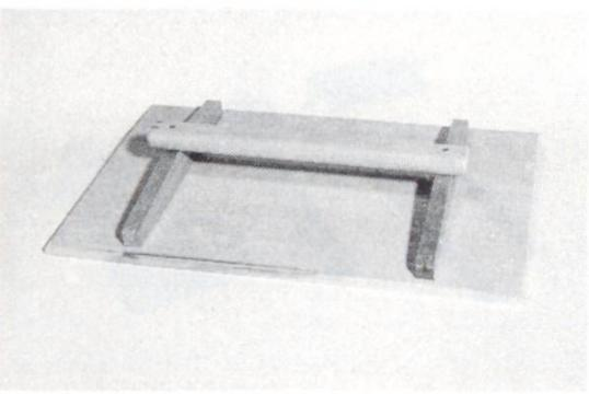
**Taloche.** Elle est utilisée comme «dépôt intermédiaire» de mortier dans les travaux de crépissage ainsi que pour égaler et structurer les surfaces des enduits. 15
