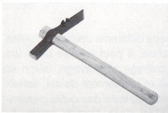
**Marteau de maçon.** Il sert à fendre les pierres, mais aussi à planter et à arracher les clous. Les briques de terre cuite sont fendues à l'aide de la panne, les pierres et les briques de ciment avec l'arête de la tête du marteau. 11
