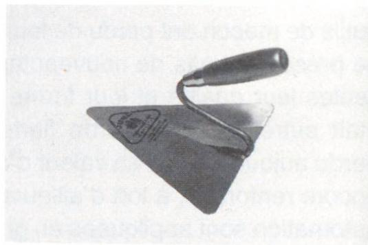
**Truelle hambourgeoise.** Outil idéal pour l'exécution de toutes les maçonneries. Grâce à sa poignée en col de cygne, elle est saisie directement au-dessus du centre de gravité de la charge de mortier, ce qui évite une inflammation du poignet causée par une excentricité de cette charge. 6
