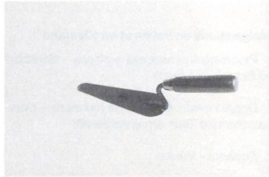
**Truelle langue de chat.** Elle est utile pour les travaux délicats tels que lissage et finissage d'arêtes, d'enduits, de regards, etc., ainsi que pour la mise en place d'éléments métalliques. 8
