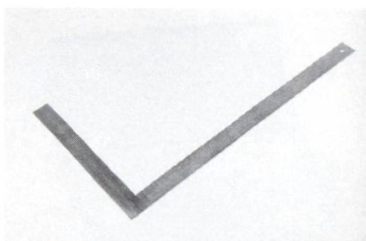
**Équerre.** Elle permet de tracer des angles droits pour de petits éléments d'ouvrage tels que parapets, portes et coffrages de tête. Elle sert aussi à marquer exactement les arêtes des briques qui doivent être partagées. 3
