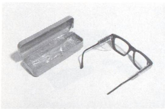
**Lunettes de protection.** Elles sont munies de verres de sécurité et doivent être portées partout où poussière, gravillon ou étincelles peuvent atteindre les yeux (projection de mortier, travaux au burin ou à la meule). Il existe des modèles spéciaux pour les porteurs de lunettes optiques. 14
