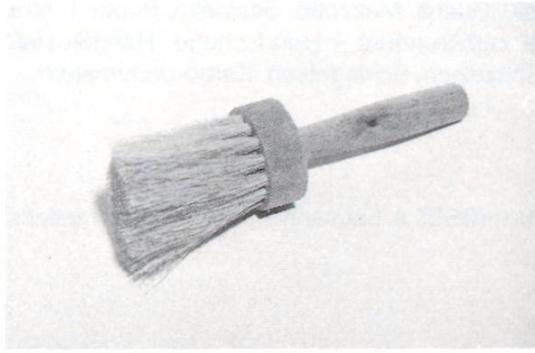
**Pinceau.** Il retient l'eau comme une éponge et accompagne le seau à eau. Il est utilisé pour asperger ou nettoyer les surfaces de support et humidifier légèrement les mortiers frais. 9
