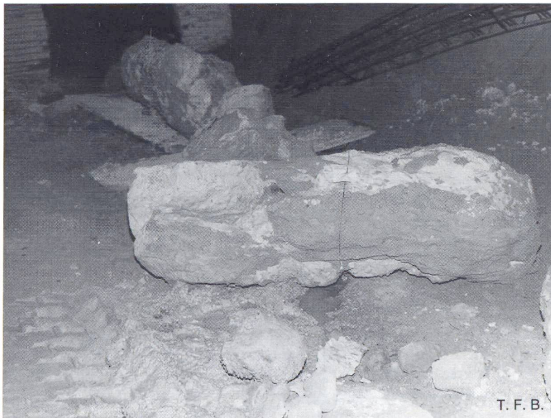
Fig. 9 Partie d'une poutre injectée. Pour tester les propriétés des matériaux, on a exécuté une poutre d'essai puis on l'a déterrée.
