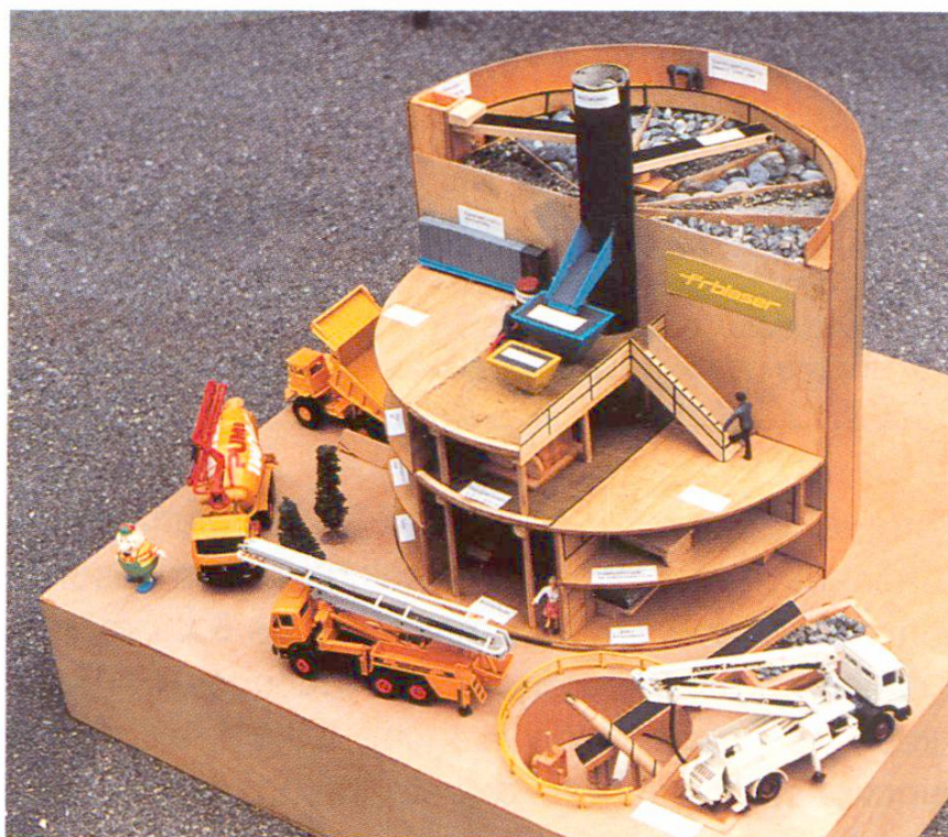
Fig. 4 Modèle en coupe. En arrière, compartiments des silos à granulats. Au milieu, élévateur central alimentant le pré-silo.
