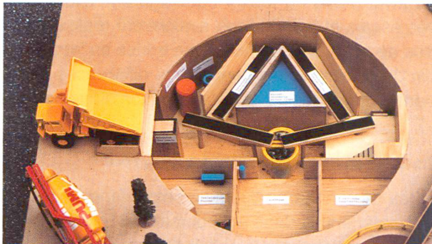
Fig. 5 Etage en sous-sol. Réservoir à eau, ruban doseur et caves.
