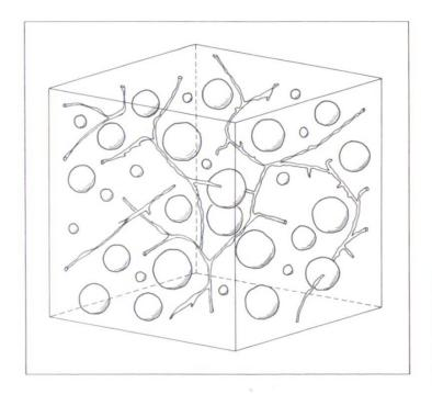
Fig. 1b Ensemble idéal de pores dans la pâte de ciment. Les pores sont sphériques et finement répartis. Ils interrompent le réseau des capillaires. Les pores du gel qui se trouvent entre les particules du gel ne sont pas dessinés.
