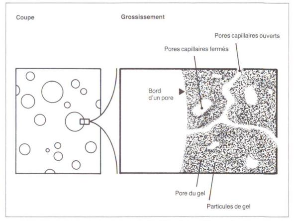
Fig. 1a Pâte de ciment avec pores d'air introduits artificiellement. Le grossissement à droite montre une fraction de pore dont le bord est formé par les particules du gel (représentation selon T. C. Powers).
