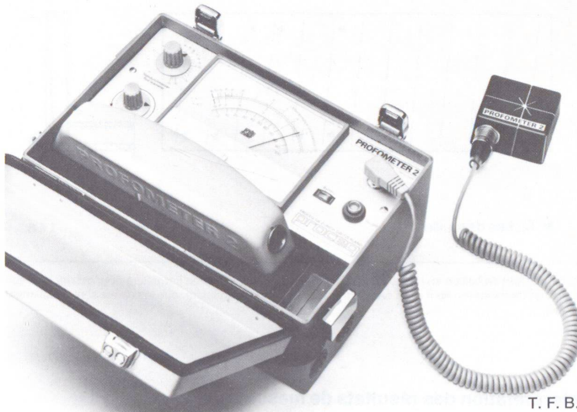
Fig. 1 Appareil électromagnétique de repérage de l'armature avec sa sonde ponctuelle. A gauche, les deux boutons, l'un pour le choix du diamètre des barres, l'autre pour la «mise à zéro».
