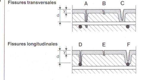
Fissures A et D: Armature en contact direct avec l'air. Corrosion indépendante de la carbonatation.
