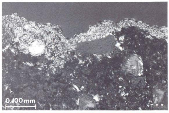
Fig. 1b Début de carbonatation à la surface d'un béton (vu au microscope). La couche de calcite a une épaisseur de 50 à 150  $\mu$ m. À la lumière polarisée elle apparaît claire, alors que la pâte de ciment alcaline reste sombre.
