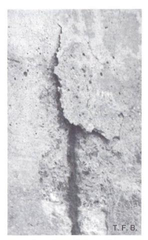
Fig. 5 Gonflement et écaillure provoqués par la corrosion de l'armature.
