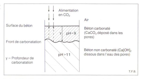
Fig. 1a Le CO<sub>2</sub> de l'air pénêtre par les pores de la pâte de ciment jusqu'au front de carbonatation. Il s'y forme de la calcite (carbonate de chaux) qui remplit partiellement les pores. L'hydrate de chaux est progressivement dissous en sorte que le front de carbonatation se déplace vers l'intérieur du béton.
