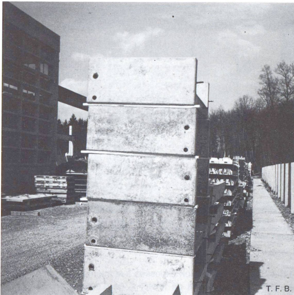
Fig. 4 Mêmes éléments mais différentes compositions du béton.
