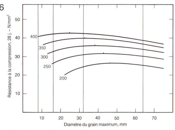
Fig. 3 Les dosages en ciment 200–400 kg/m³ des bétons plastiques de la Fig. 2. On constate des maxima de résistance pour certains dossages et certains diamètres du grain maximum. Plus le dosage est élevé, plus le grain maximum pour lequel la résistance est optimale est petit. Voir aussi «BC», Nos 14 et 21/1965).
