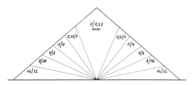
Fig. 1 Tendance à la ségrégation d'un mélange sable et gravier 0-32 mm déversé sur un tas. Cette répartition schématique montre bien qu'en pareil cas extrème, il est impossible de prélever des échantillons représentatifs.
