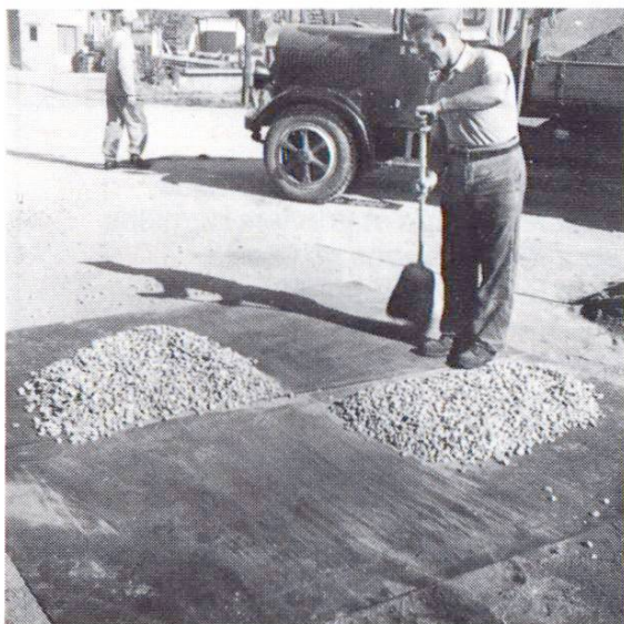
Fig. 5 à 8 Diminution du volume d'un prélèvement par la méthode des quarts
