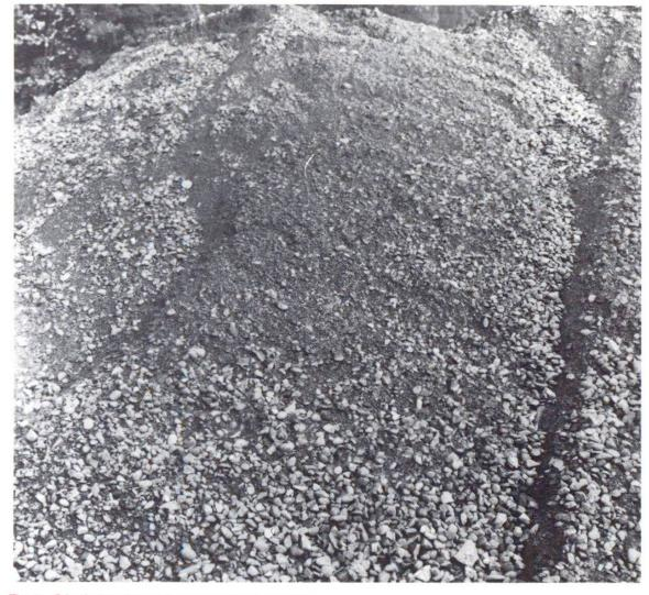
Fig. 3 Ségréation des grains dans un dépôt en tas.
