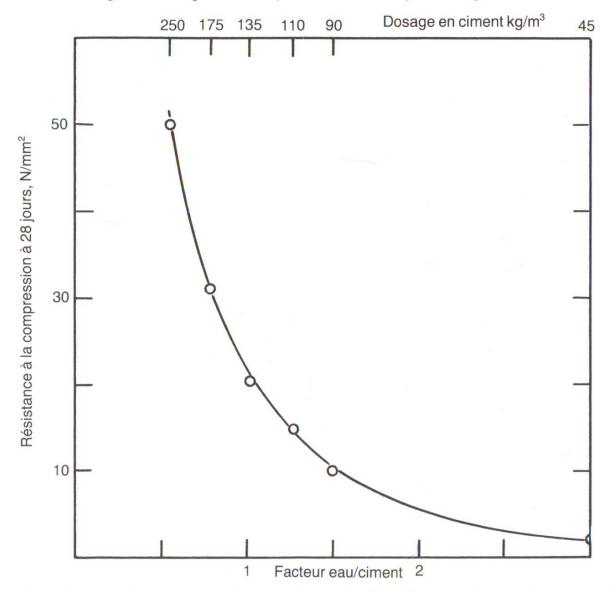
Fig. 2 Résistance à la compression de bétons maigres en fonction du facteur eau/ciment et du dosage. Selon Williams (1)
