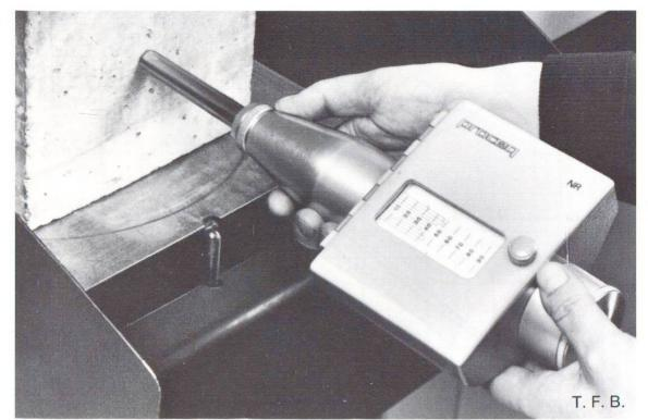
Fig. 4 Scléromètre «Schmidt», modèle NR étalonné dans une centrale à béton sur un échantillon de la qualité de sa fabrication courante.
