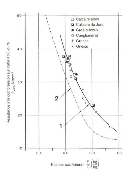
Fig. 1 Relation entre la résistance à la compression et le facteur eau/ciment de bétons de granulats concassés de différentes roches. Courbe 1:  $\beta_{w28} = 14.66 \cdot \left(\frac{E}{C}\right)^{-1.9}$
